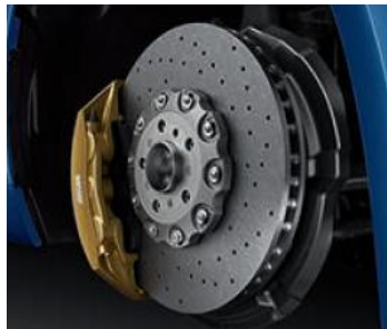
Los frenos cerámicos de carbono ofrecen la mayor resistencia a la fatiga y a la corrosión. Son más ligeros que los frenos convencionales, los calipers tienen el logo M y están pintados en color oro mate. Opcional.
